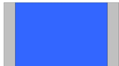
Das Bild aus der Kompaktkamera mit seinen 800x600 Pixel wird auf 1440x1080 Pixel gerechnet. Hier bleiben dann sogar 240 Pixel auf jeder Seite ungenutzt.
